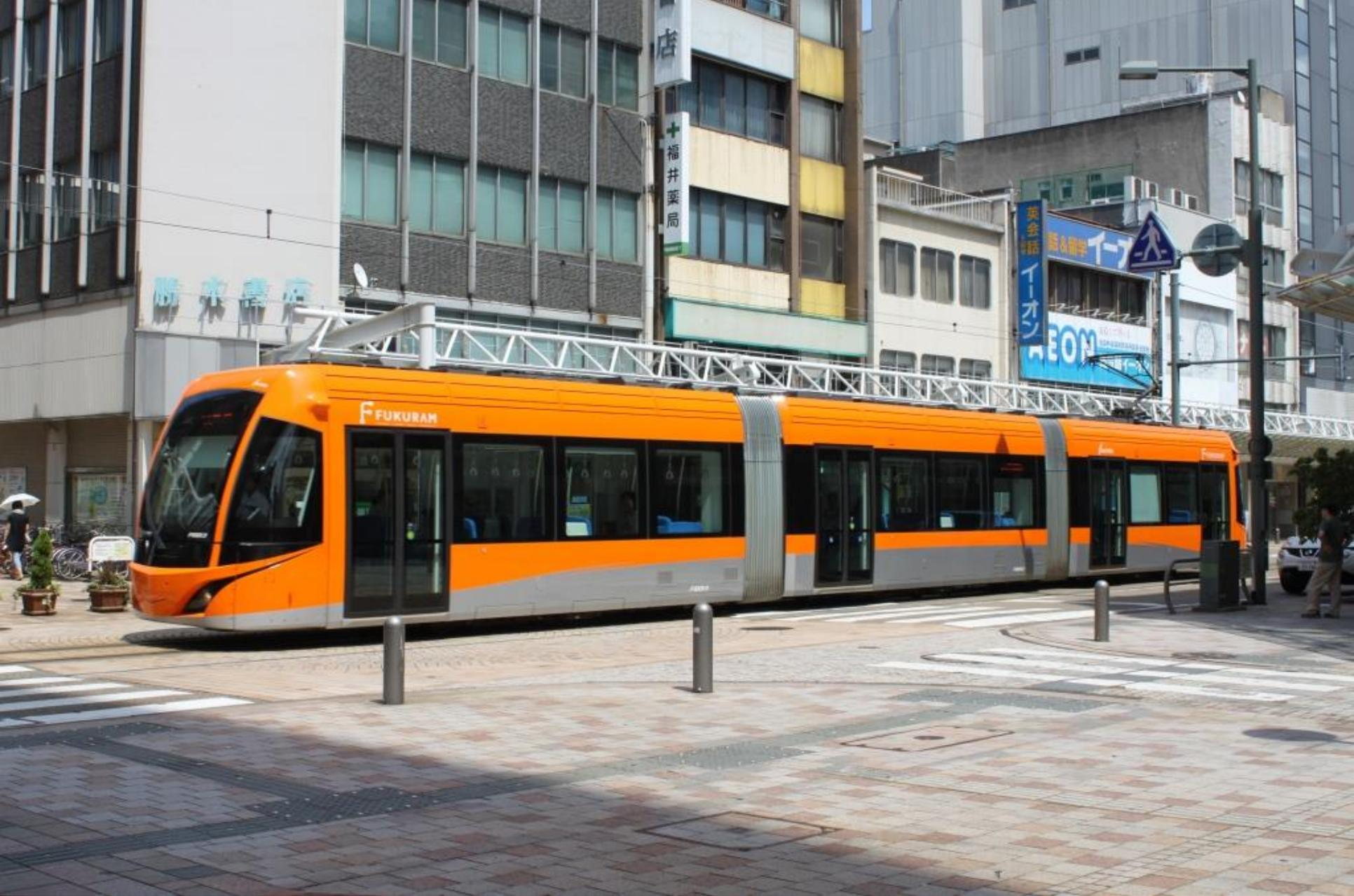
大型の旧型車両の置き換えで全長27m、幅2.65mの低床車両導入
