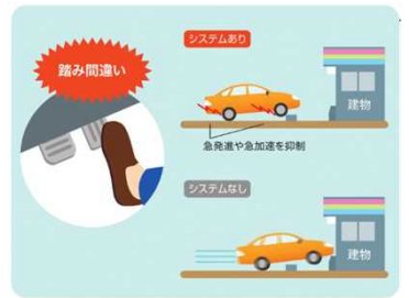
ペダル踏み間違い急発進抑制装置
